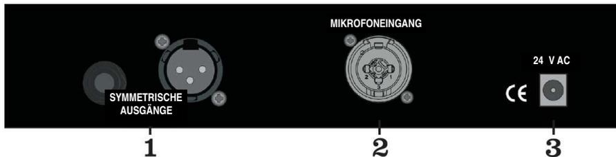
**1. XLR- und TRS-Ausgänge.** Zwei symmetrische XLR- und TRS-Ausgänge. Diese Ausgänge können gleichzeitig verwendet werden. Bei der Verwendung von zwei WA12 als Mastering-Bus in Stereo können die Ausgänge eines WA12 den Lautsprechern zugeordnet werden, während die Ausgänge des zweiten Vorverstärkers das bearbeitete Signal zur Aufnahme in die DAW zurückführen.
